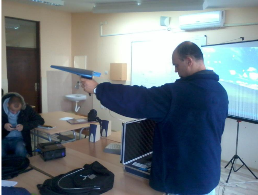
Слика 42: Поступак мерења нивоа нискофреквентног зрачења инструментом SPECTRAN XF 60105 у ЕТШ „Никола Тесла“ у Нишу
